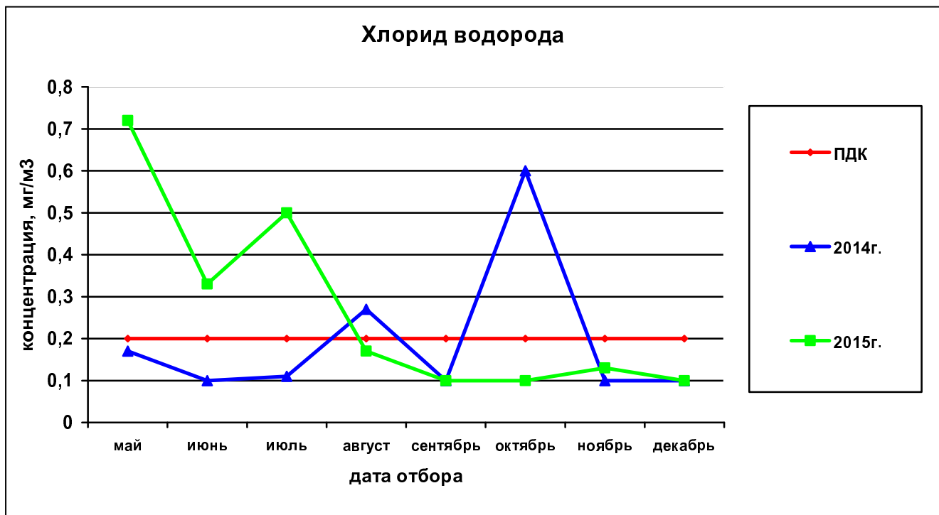
Рисунок 32— Сравнительная характеристика изменения концентрации хлорида водорода в атмосферном воздухе на ул. Строителей за 2014 и 2015гг.
