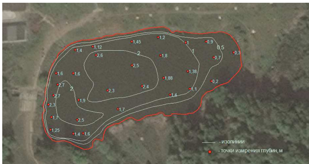
Рис. 5 Схема глубин пруда Андроновский-2 по результатам батиметрической съемки 2016 г.
